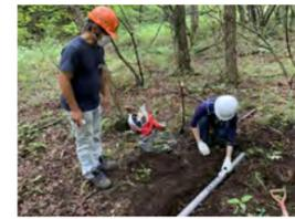
9月2日:火山体を構成する多様な火砕堆積物や熱水により大きく変化する地下の比抵抗の空間分布を推定するMT法の原理の講義がありました。1日目に設置した機器から半日分のデータを回収し、MT法による解析方法を習得しました。
