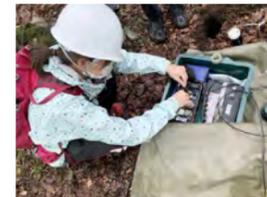
9月3日:2日間のデータを回収し、鉛直方向のみに比抵抗が変化する1次元モデルを仮定して、得られたデータを説明できる地下の比抵抗分布を推定しました。
