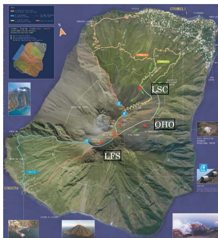
図1：観測点配置図。赤星が3成分短周期地震計、大赤星が上下動地震計アレー。赤星横の文字は観測点名。
